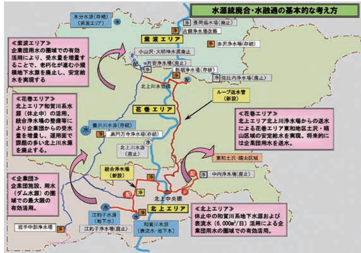
図-4 水源統廃合・水融通の基本的な考え方
