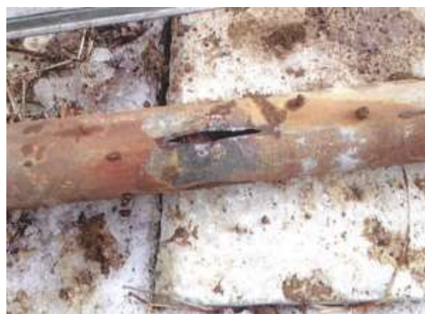
②保温対策がされていない露出配管からの漏水
