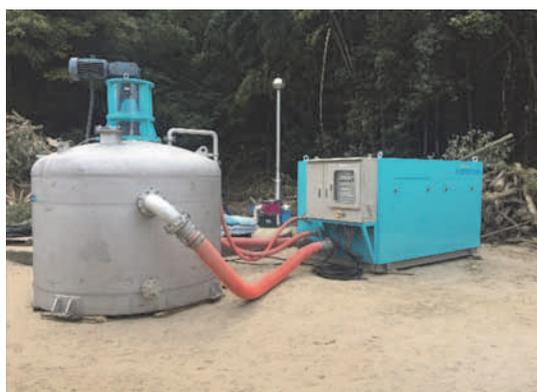
図-3 仮設浄水装置設置の様子
