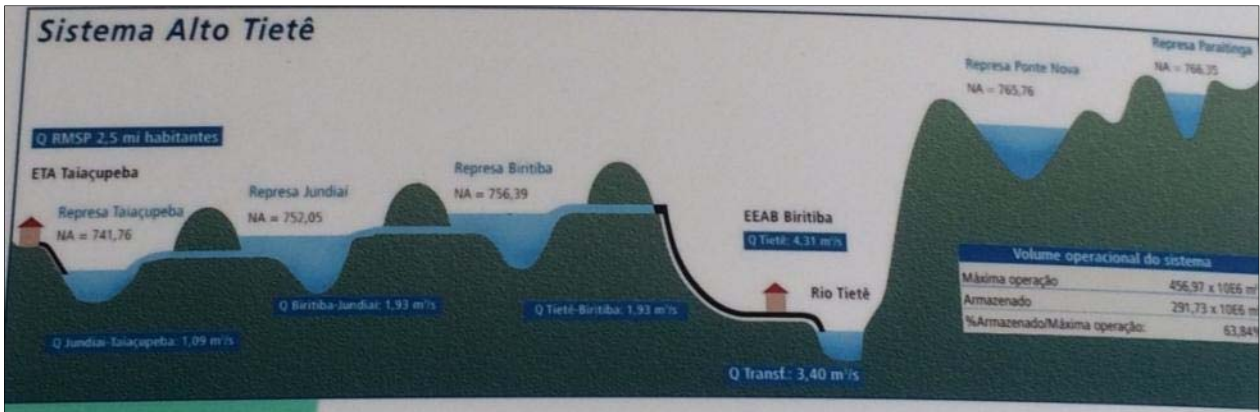
図 アルト チエテ配水システム ダムから浄水場までの概要図
