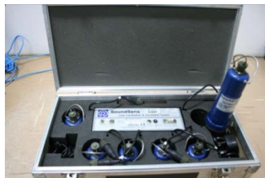
相関式漏水探知器
