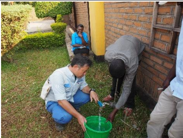
メーターの精度確認調査の実施
