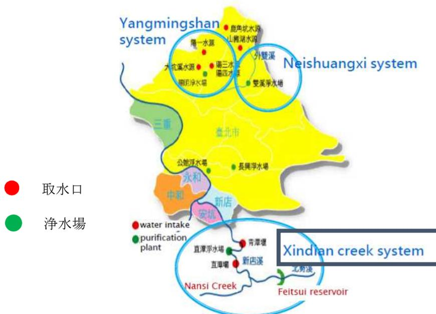
図 26 原水と浄水場
