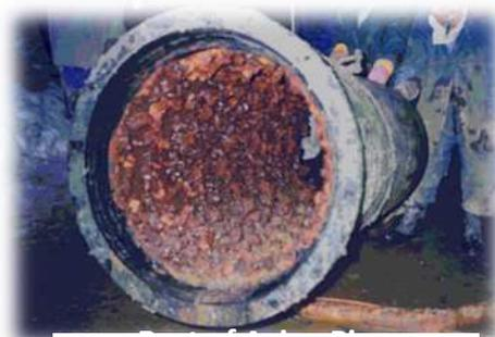
※老朽管内の鉄錆
