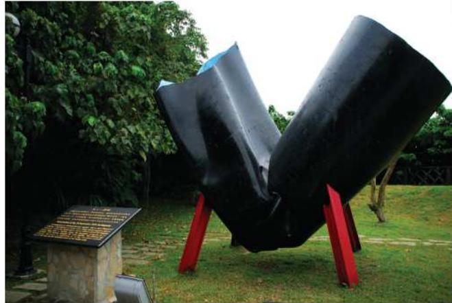
※損傷した鋼管 φ 2000
