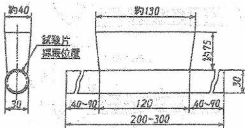
備考 試験片は、図に二点鎖線で示した供試材の下辺に近い位置から採取する。
