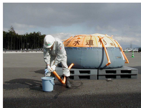
簡易給水槽・仮設水槽
