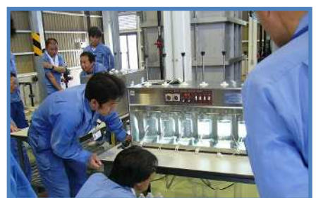
水質基準と凝集沈殿・配水・給水過程の水質管理の方法を習得できる。
