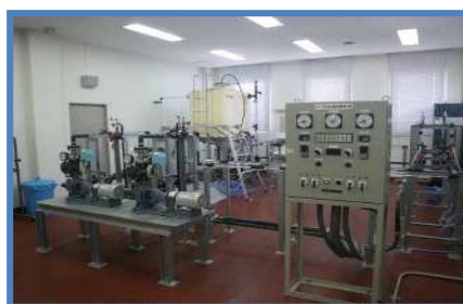
ポンプ実流実験装置でポンプの運転特性、省エネルギーや流量計等の調整を実習できる。
