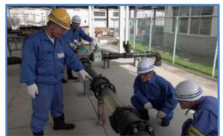
透明アクリル管を使用して管内の水や堆積物の動きを確認し、断通水計画が習得できる。
