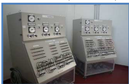
シーケンス実習装置で制御回路の構成、動作や不良箇所の調査・対応を実習できる。
