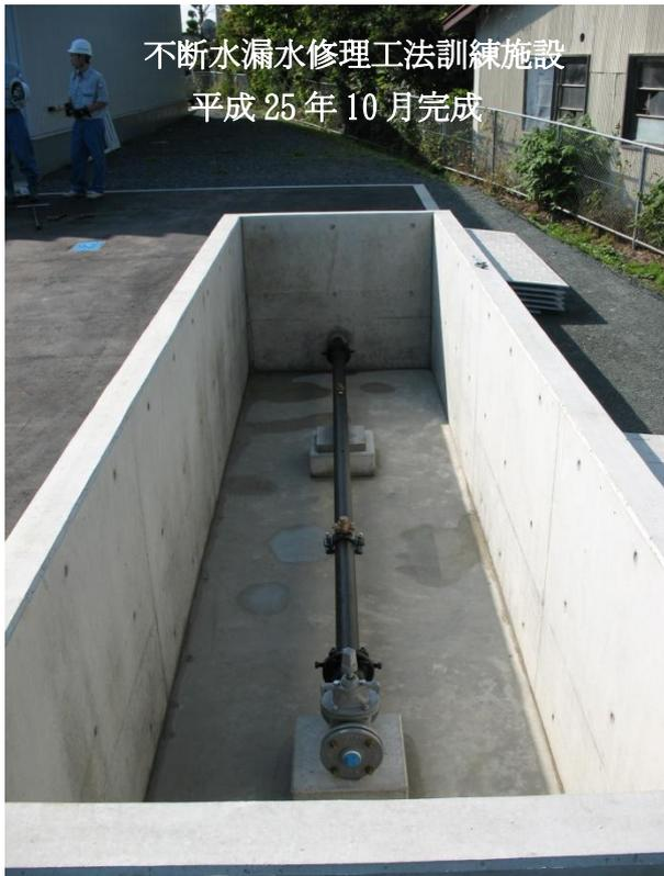
不断水漏水修理工法訓練施設
