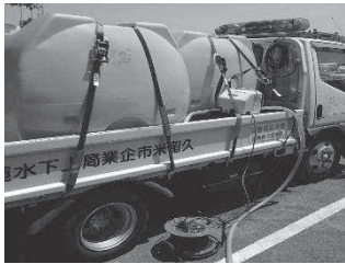
写真-1 給水装置(大型タンク)
