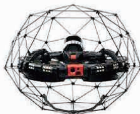
調査に使用したドローン
