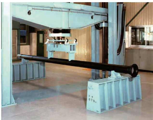
圧力を加える前（左）と圧力を加えた後の水道管。圧力を加えることで管がたわむことがわかる。
