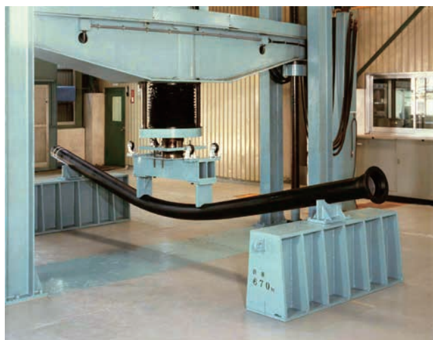
圧力を加える前（左）と圧力を加えた後の水道管。圧力を加えることで管がたわむことがわかる。
